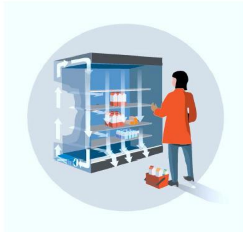
Figur 1 Luftgenomströmning och luftfridå i en vertikal disk. Kylbatteriet är här placerat i diskens bakre nederkant.
